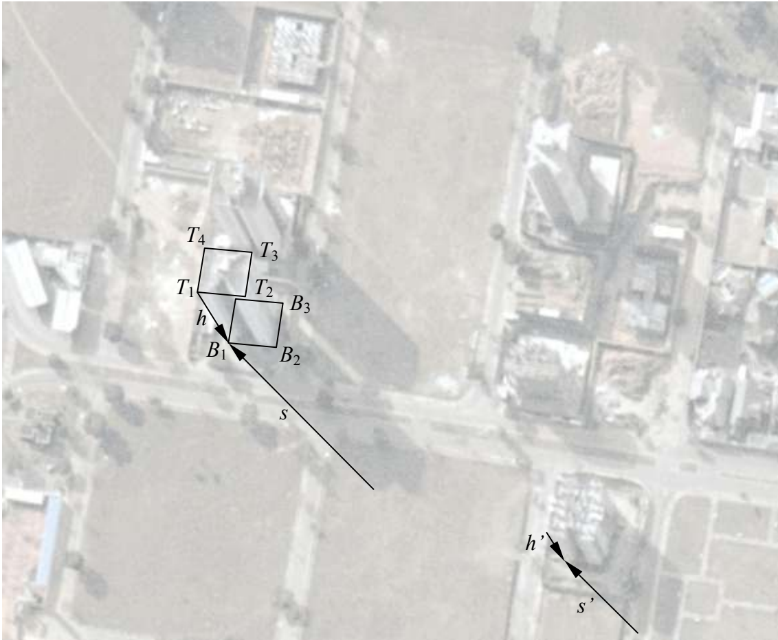
Fig. 2.1 – Imagem aérea e os principais pontos que devem ser utilizados no processo de reconstrução. O contraste da imagem foi reduzido artificialmente para evidenciar os pontos a serem fornecidos externamente.
